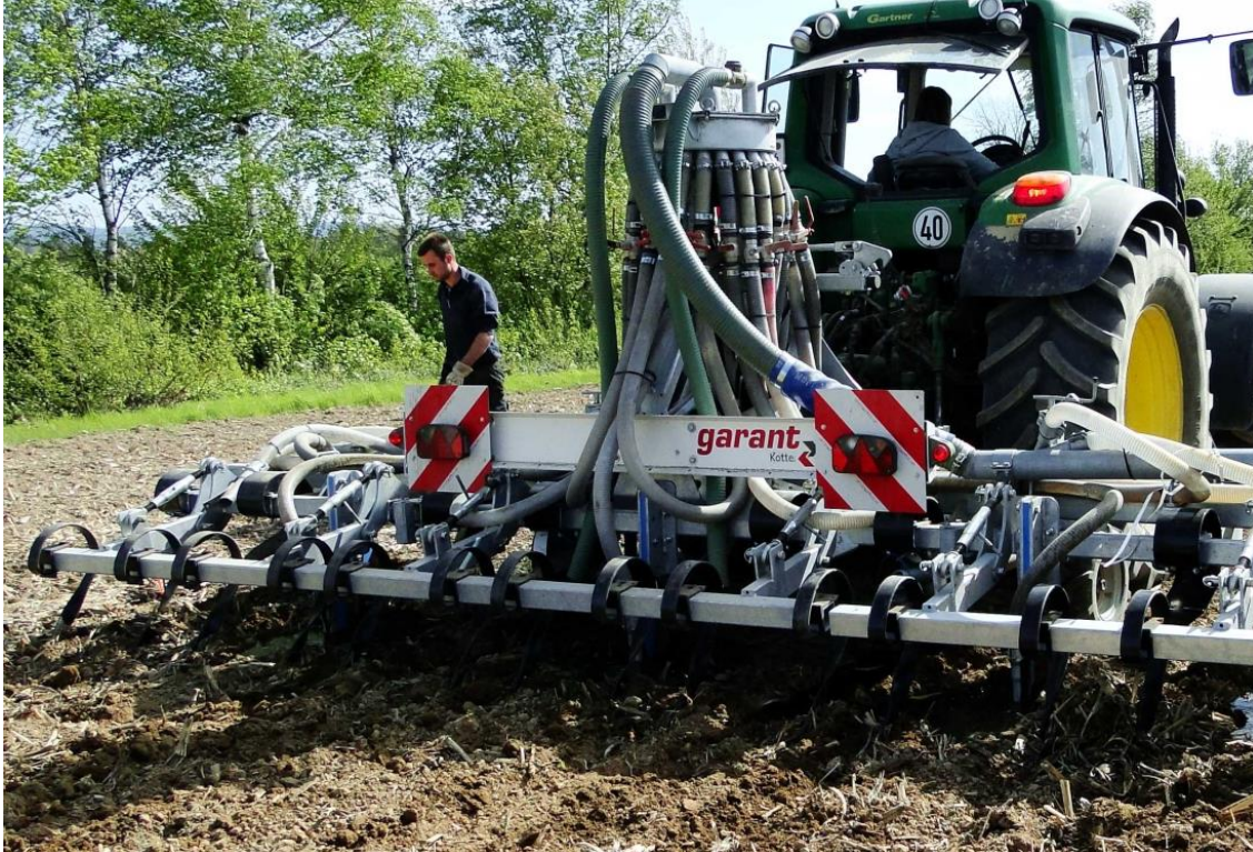
Foto 2 Grubber mit aufgesatteltem Verteilerkopf zur Anlage der Nährstoffdepots
