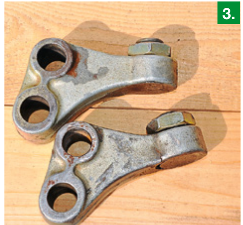
1. Höhenverstellbare Kugeln sind meist auf 2 t Stützlast begrenzt. 2. Extremes Beispiel für Verschleiß. Wichtig ist vor allem ein korrekt eingestellter Niederhalter. 3. Der untere Niederhalter ist wahrscheinlich beim Kuppeln verbogen: austauschen!
