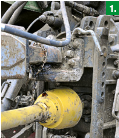
1. Höhenverstellbare Kugeln sind meist auf 2 t Stützlast begrenzt. 2. Extremes Beispiel für Verschleiß. Wichtig ist vor allem ein korrekt eingestellter Niederhalter. 3. Der untere Niederhalter ist wahrscheinlich beim Kuppeln verbogen: austauschen!
