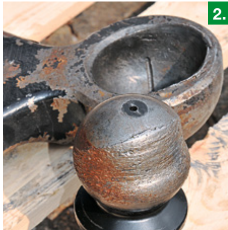
1. Höhenverstellbare Kugeln sind meist auf 2 t Stützlast begrenzt. 2. Extremes Beispiel für Verschleiß. Wichtig ist vor allem ein korrekt eingestellter Niederhalter. 3. Der untere Niederhalter ist wahrscheinlich beim Kuppeln verbogen: austauschen!
