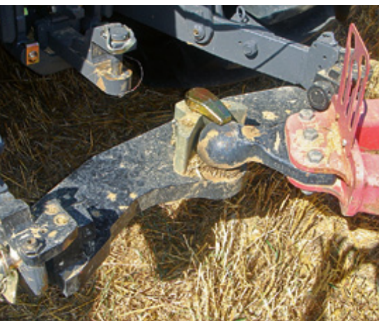
Traverse für die Unterlenker mit Kugelkupplung: einfaches Kuppeln, enge Wendungen; aber nur für Arbeitsgeräte.
