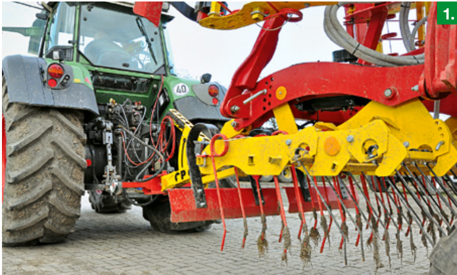
1. In den Unterlenkern dürfen nur Arbeitsgeräte gefahren werden. Die Spritze ist erlaubt, der Großflächenstreuer nicht. 2. Legale Alternative zum Pkw-Kugelkopf auf der Ackerschleife: bauartgeprüfte Kupplung für den Anbaubock.
