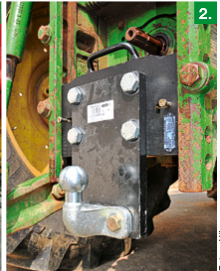
1. In den Unterlenkern dürfen nur Arbeitsgeräte gefahren werden. Die Spritze ist erlaubt, der Großflächenstreuer nicht. 2. Legale Alternative zum Pkw-Kugelkopf auf der Ackerschleife: bauartgeprüfte Kupplung für den Anbaubock.
