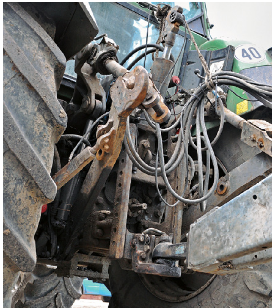
Nahezu spielfrei hohe Stützlasten übertragen: Die Kugelkupplung setzt sich immer mehr durch. Allerdings werden Wartungsaufwand und Verschleiß oft unterschätzt.
