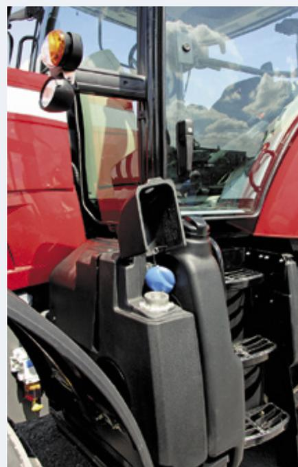
*Zusätzlicher AdBlue-Tank an einem MF 8600.*
