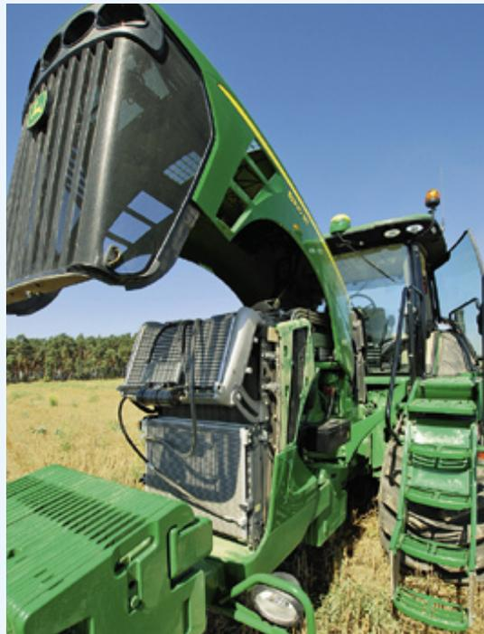
Unter anderem John Deere (Bild oben) setzt bei der Tier 3B weiter auf die gekühlte Abgasrückführung. Dann geht es nicht ohne einen Diesel-Partikelfilter.
