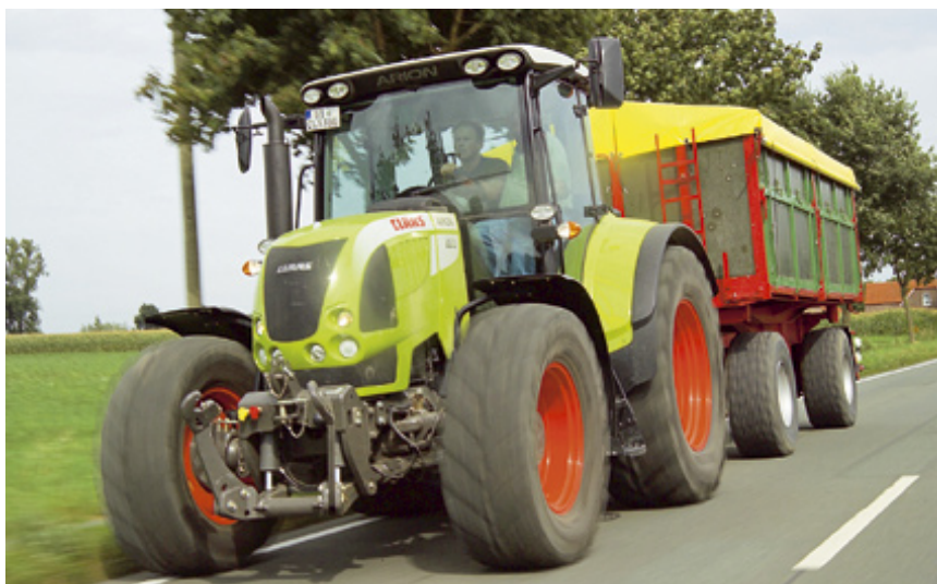
Auf der Straße sorgt hoher Reifendruck für weniger Rollwiderstand und geringeren Verschleiß. Auf dem Acker muss der Druck runter. Der Aufwand lohnt sich!
