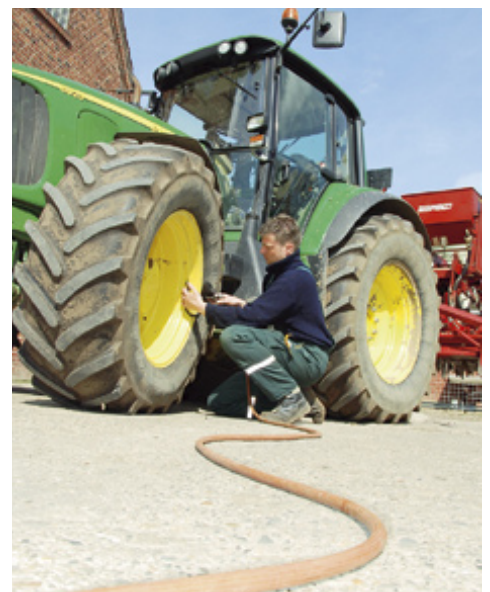
Auf der Straße sorgt hoher Reifendruck für weniger Rollwiderstand und geringeren Verschleiß. Auf dem Acker muss der Druck runter. Der Aufwand lohnt sich!
