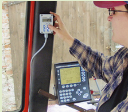
Auch ältere Schlepper können mit einem Verbrauchs-Messsystem nachgerüstet werden. Die Messturbinen erfasst auch die Rücklaufseite. Der Verbrauch sollte sich auch pro ha oder pro km anzeigen lassen. Fotos: Einhoff, Heil, Höner, Werkbilder
