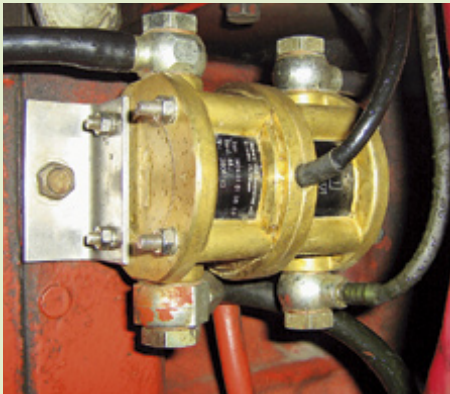
Auch ältere Schlepper können mit einem Verbrauchs-Messsystem nachgerüstet werden. Die Messturbinen erfasst auch die Rücklaufseite. Der Verbrauch sollte sich auch pro ha oder pro km anzeigen lassen. Fotos: Einhoff, Heil, Höner, Werkbilder
