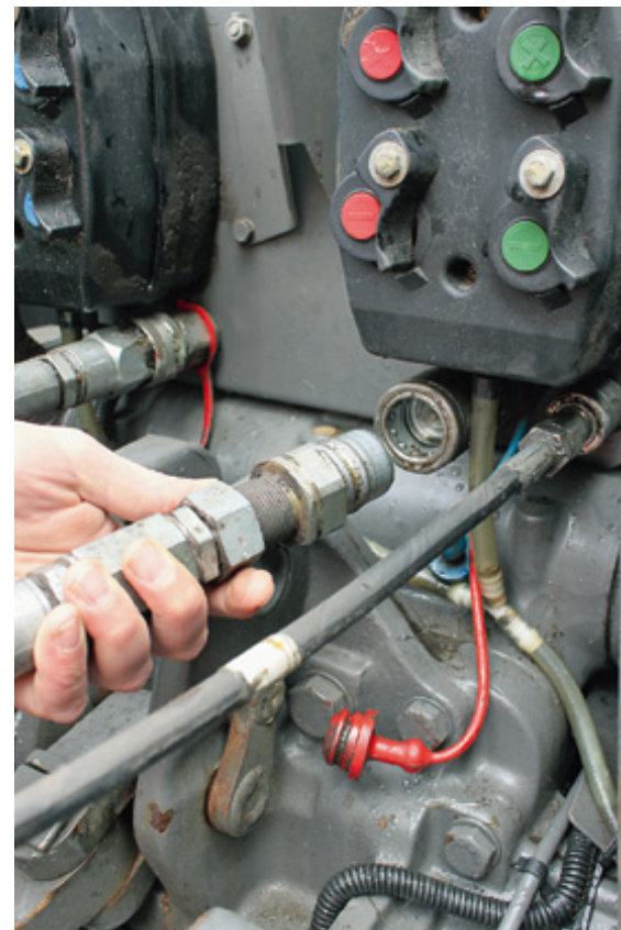
Power-Beyond-Anschluss: Über die linke dünne Steuerleitung wird die Pumpe des Systems bedarfsgerecht geregelt.
