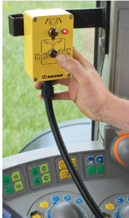
Bei der elektrischen Vorwahl schaltet man das Ventil und führt dann die Funktion mit dem Schlepper-Steuerg r t aus.
