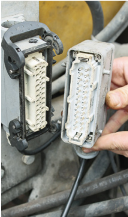
Nachteil eines elektrischen Systems: Jede Funktion benötigt ein eigenes Kabel und damit große Steckverbindungen.
