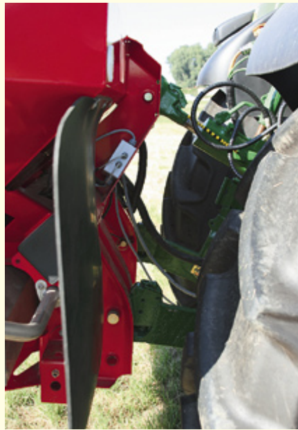
Rauch-Streuer mit elektrischem Antrieb: Komfort ohne Zapfwelle!
