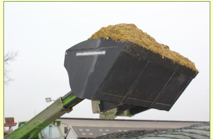
hochverschleißfester Unterbau Hardox 500 HB
