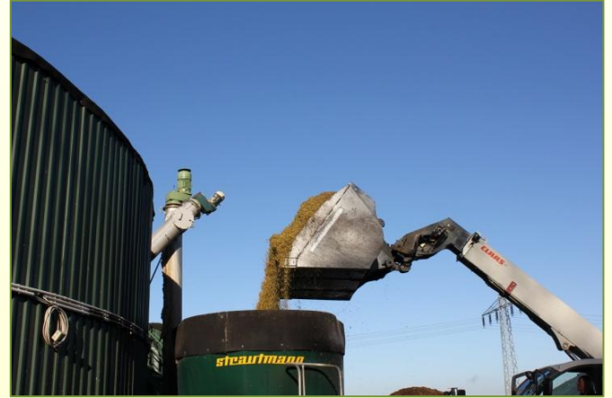
gerundeter Schaufelboden - sauberes Entleeren
