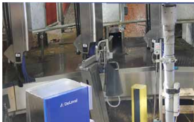
Reinigen: Nachdem die Kuh das Karussell verlassen hat, werden die Standfläche sowie die Melkbecher gereinigt.
