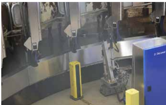
Dippen: Am Ende des Karussells ist ein Roboter installiert, der alle vier Zitzen dippt. Fotos: Liste
