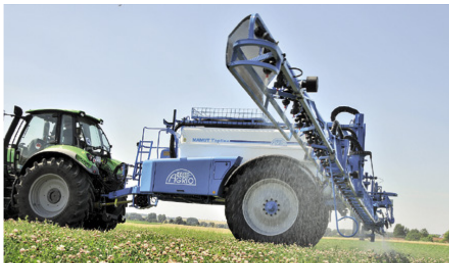
Bei Agrio steuert der Fahrer die Reinigung vom Schlepper aus. Die Ventile arbeiten pneumatisch. Die ATS arbeitet genau, die Abweichungen liegen deutlich unter 1 m.
