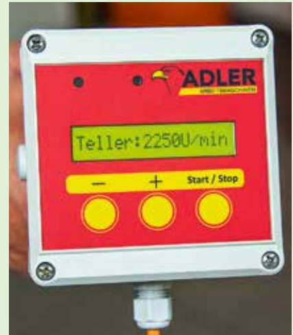
Die Drehzahl wird an der Box voreingestellt, der Schieber am Streuer selbst.
