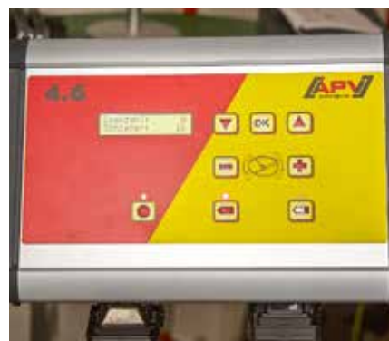
Die Bedieneinheit des ZS 200 regelt Schieberstellung und Drehzahl.
