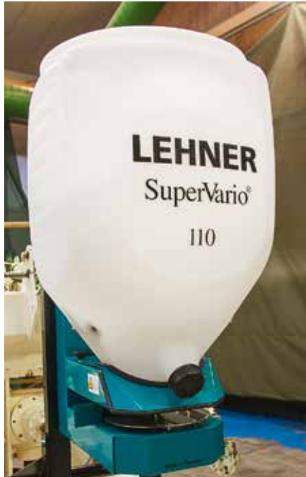
Der Behälter kann mit wenigen Handgriffen abgenommen werden.
