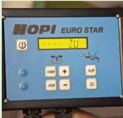
Die Box regelt die Drehzahl und öffnet den Schieber.
