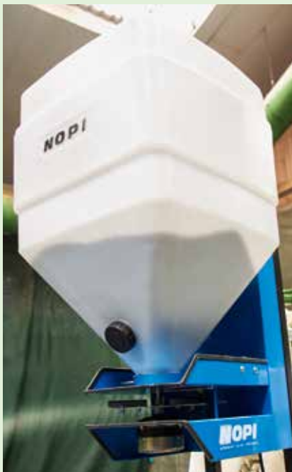
Bis 12 m lässt sich Schneckenkorn mit dieser Motorvariante streuen.
