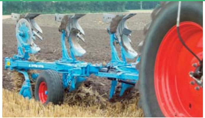
Sitzt das Stützrad weiter vorne, wird der Oberlenker im Festloch angebaut. Das gilt vor allem für drei- und vierfurchige Pflüge.
