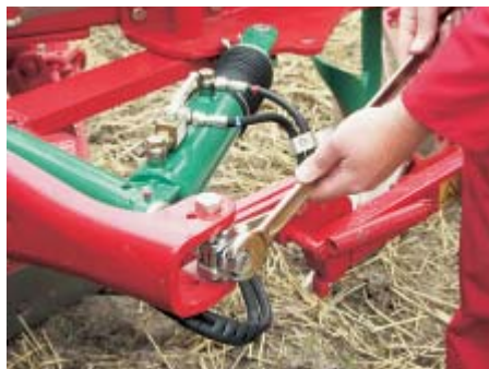
Lenkerpflug mit Spindeln für Vorderfurche und Zugpunkt.
