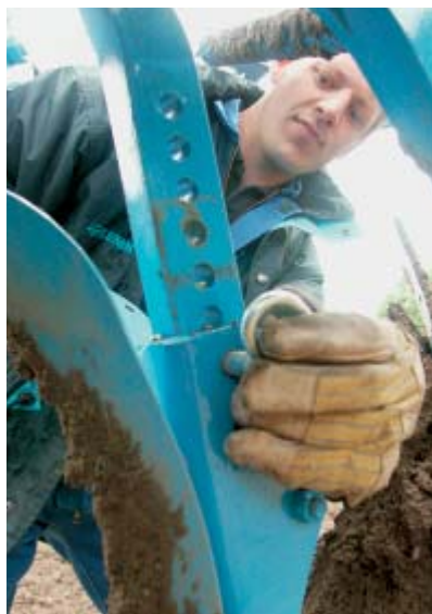
Gut lassen sich Tiefe und Winkel der Vorschäler mit Steckbolzen einstellen.
