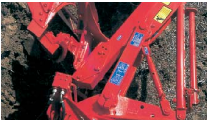
Bei vielen Pflügen kann die Arbeitsbreite durch Umschrauben der Grindel verstellt werden. Das wird leider zu selten gemacht.
