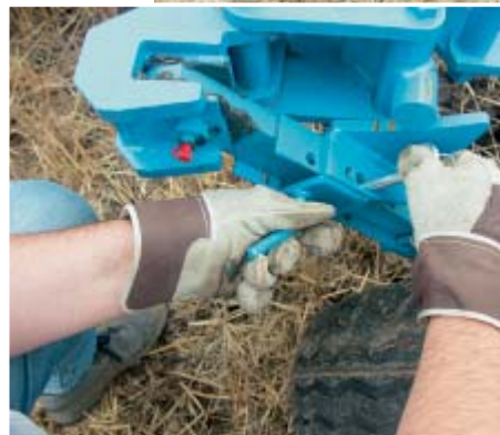
Bei Stützrädern mit getrennter Höheneinstellung werden beide Spindeln immer mit der gleichen Umdrehungszahl verstellt.
