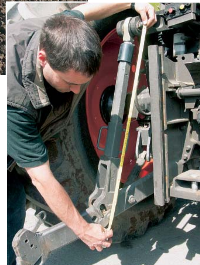
Die Hubstreben sollen gleich lang und so kurz wie möglich sein. Prüfen Sie auch den Reifendruck.
