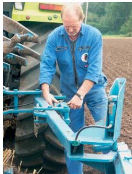
Der Abstand des Nachläufers wird am Packerarm eingestellt.
