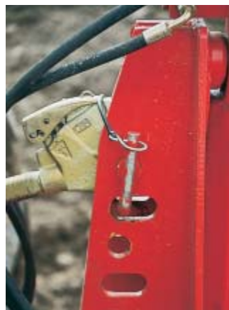
Festloch oder Langloch? Die Position des Rades entscheidet.
