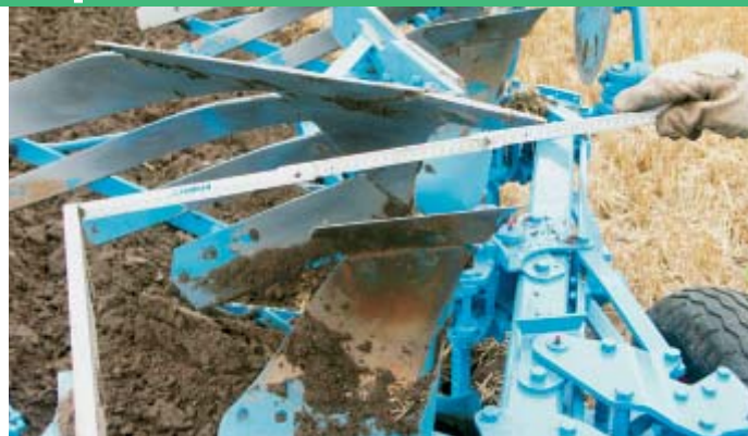
Arbeitsbreite: Von der Anlage bis zur Scharspitze des folgenden Körpers messen und den Wert mit der Körperzahl multiplizieren.
