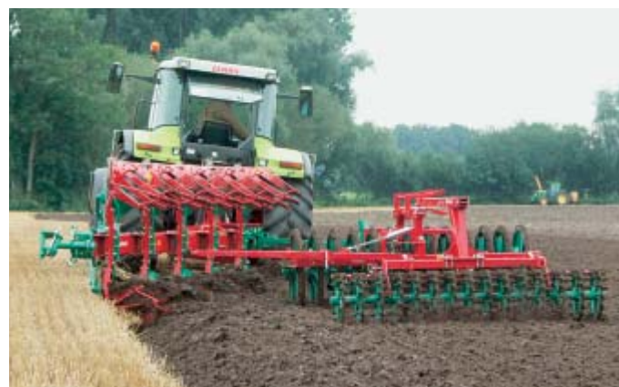
Ein Packer erhöht den Seitenzug zum Gepflügten. Der Nachläufer sollte deshalb möglichst nah am Pflug laufen.
