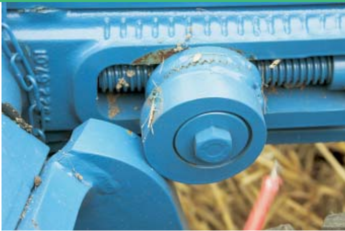
Zentrale Tiefeneinstellung per Spindel oder über Steckbolzen (unten) für beide Seiten.
