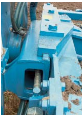
Schlittenpflug mit Einstellspindel für die Vorfurchenbreite.
