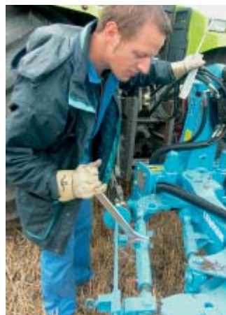
Lenkerpflug mit Spindeln für Vorderfurche und Zugpunkt.
