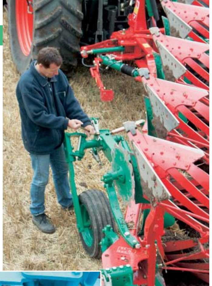
Bei Stützrädern mit getrennter Höheneinstellung werden beide Spindeln immer mit der gleichen Umdrehungszahl verstellt.
