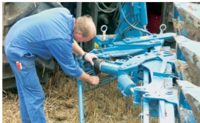
Bei richtig eingestelltem Zugpunkt zieht der Schlepper leicht zum Gepflügten. Das entlastet die Anlagen und spart Diesel.
