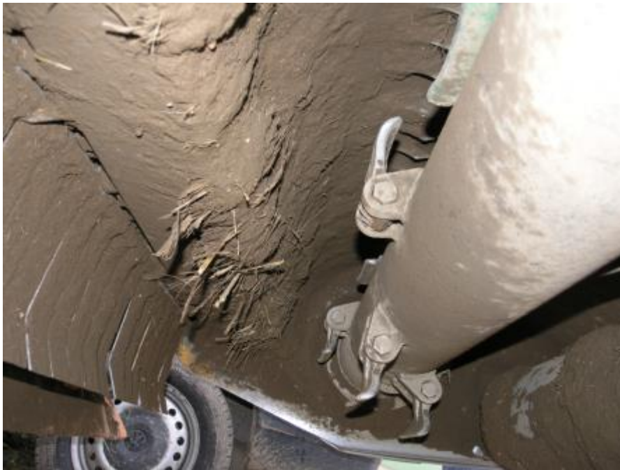
Abbildung 34: Werkzeugverschleiß und Ablagern von Boden im Gehäuse (Schlegelmulcher MU-Pro)
