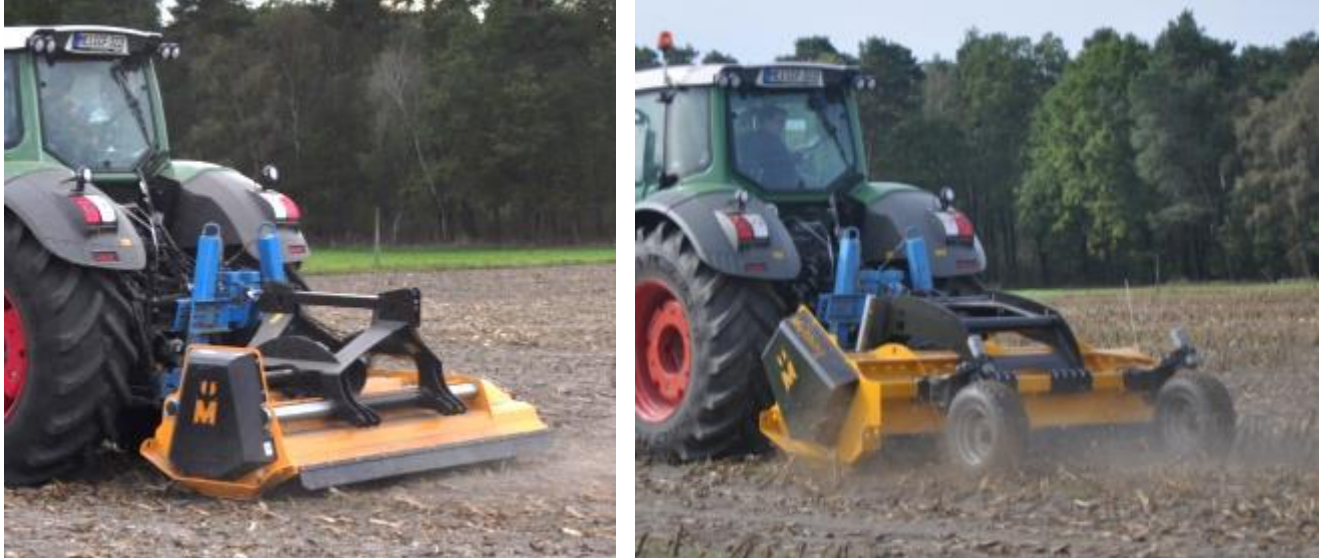
Abbildung 4: Schlegelmulcher MU-Pro 280 (links) und MU-Farmer 280 (rechts), Arbeitsbreite 2,8 m
