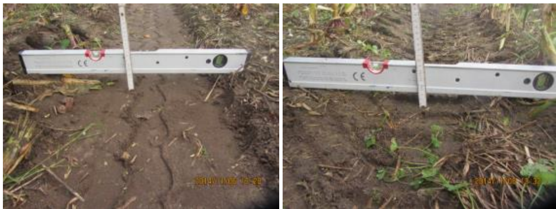
Abbildung 43: Spurbildung Diagonalreifen bei 4-fach-Überrollung und Radialreifen bei 2-facher und Radlast (3000 kg und 3200 kg)
