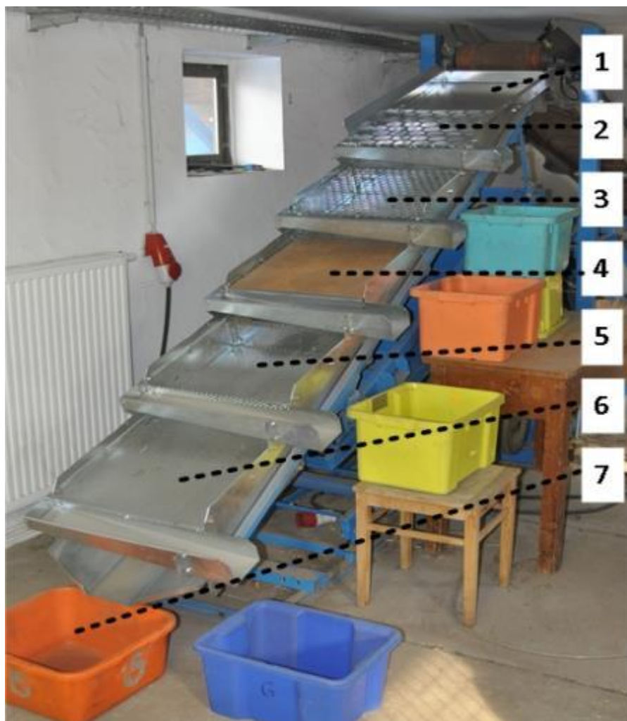
Abbildung 8: Schwingsieb zur Bestimmung der Fraktionsanteile aus den Materialproben
