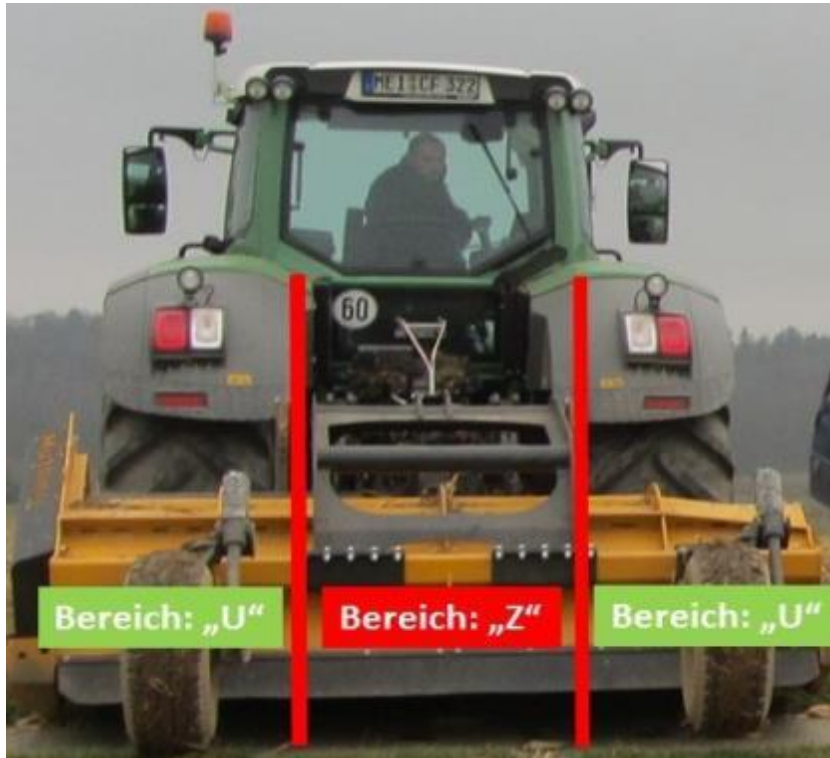
Abbildung 11: Arbeitsbereiche am Heckmulcher
