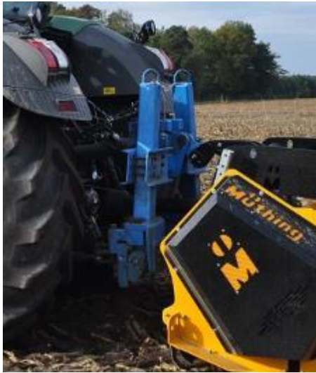
Abbildung 5: Mehrkomponenten-Kraftmessdreieck (links) und Zapfwellen-Messflansch (rechts)
