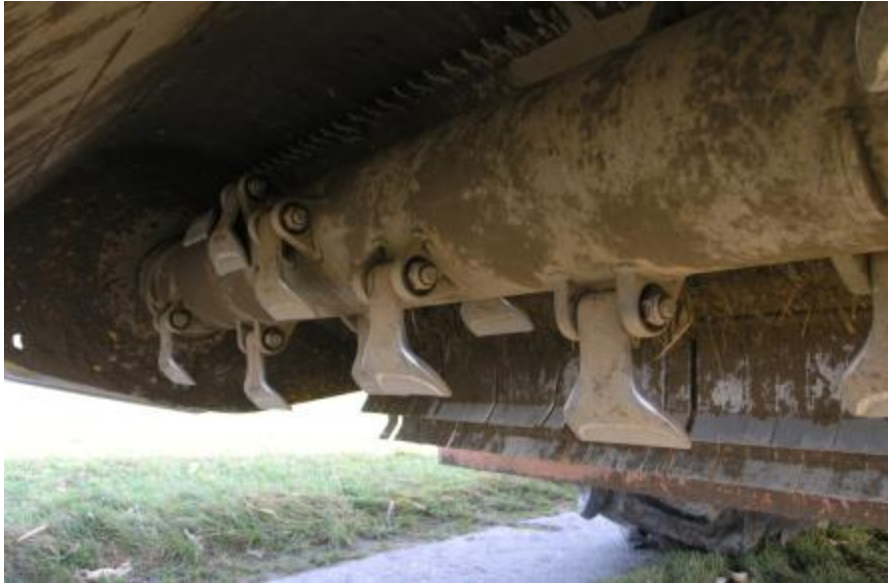
Abbildung 48: Werkzeugrotor und Gehäuse nach tiefem Mulchen bei Bodenkontakt (schwere Mulcherausführung, MU-Farmer)
