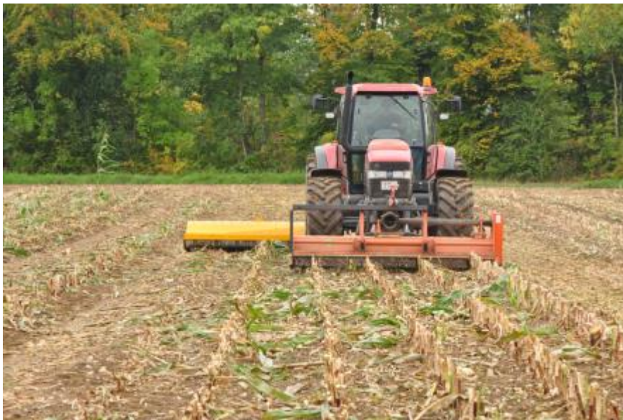
Abbildung 50: 6-reihiges Mulchen mit 2-teiliger Front-Heck-Schlegelmulcherkombination
