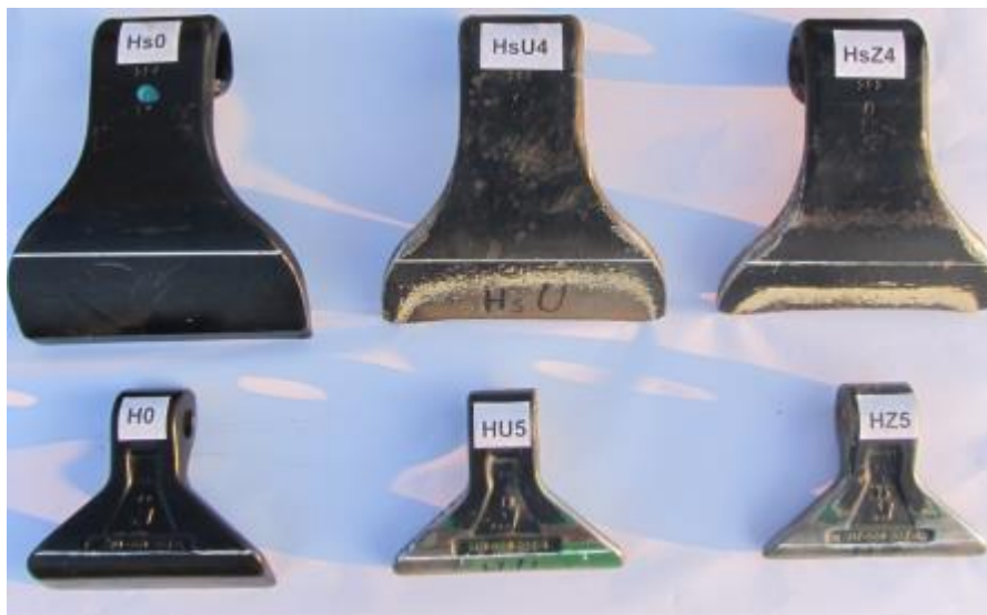
Abbildung 33: Verschleiß an Hammerschlegeln
