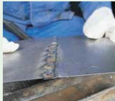
Saubere Verbindung mit abgesetztem Blech und Lochpunkt-Schweißnaht.
