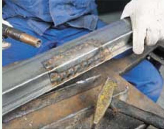
*Eine haltbare Verbindung ergibt auch das Schweißen mit einem hintergelegten Blechstreifen. Löcher in Profilen werden mit passend geformten Blechflicken repariert.*
