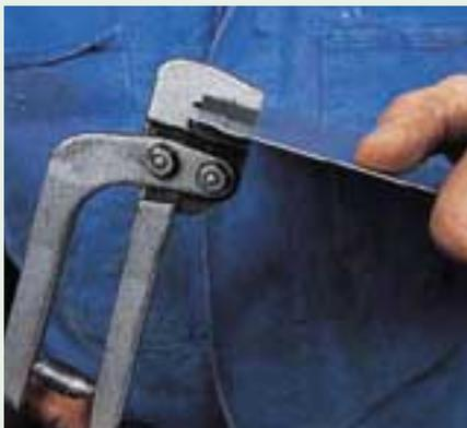
Absetzen eines Blechs mit einer speziellen Absetzange.
