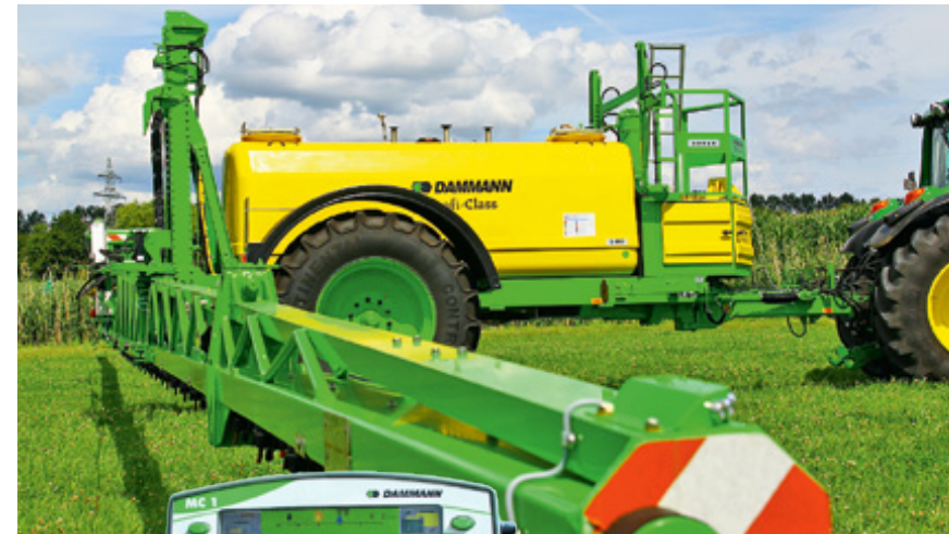
Die Dammann erreichte mit der vollautomatischen Reinigung das zweitbeste Ergebnis. Das Programm erfasst auch die Einspülschleuse.
