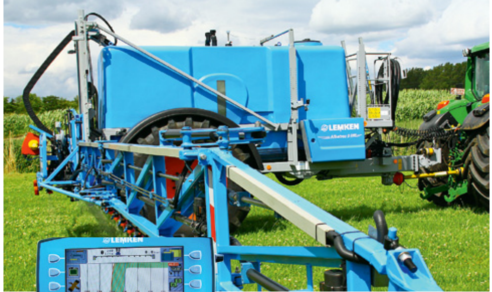
Die Lemken erreichte mit der manuellen Fernbedienung die intensivste Reinigung. Allerdings muss der Fahrer alle Schritte im Kopf haben und auch die Wassermenge selbst einteilen.
