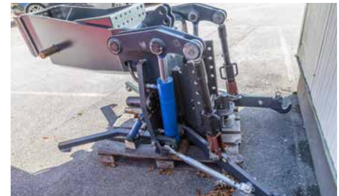
Für Standardgeräte gibt es einen Adapter mit Dreipunkthubwerk und Rasterschiene.
