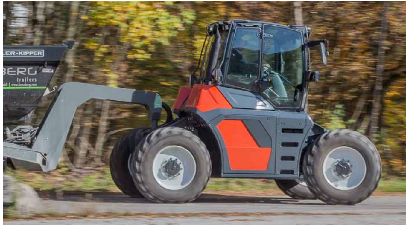
Die neu entwickelte Gerätekupplung unterscheidet den Syn Trac von anderen Systemfahrzeugen.
