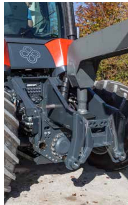
Das Kuppeln des Adapters inklusive aller Anschlüsse erfolgt automatisch.
