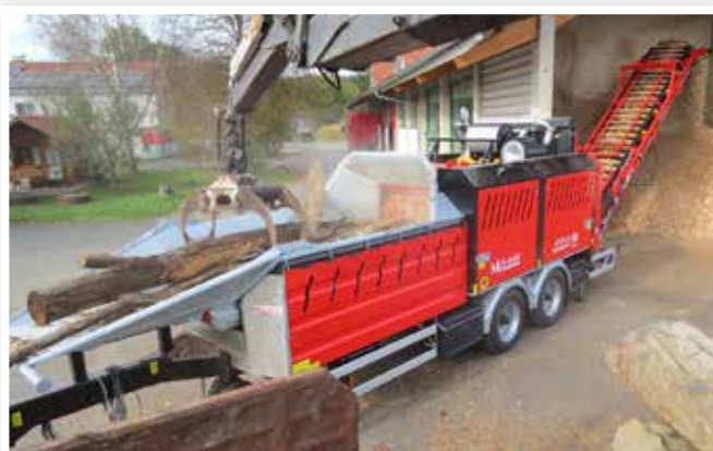
Ein beliebtes Stationärgerät für Heizwerke ist der Wood-Terminator 10 XL DLB mit einem 775-PS-CAT-C18-Dieselmotor.
