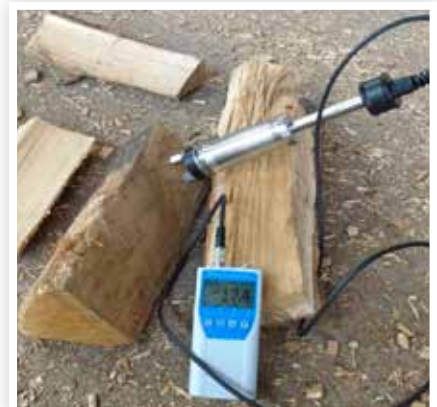
Messung des Wassergehalts von Stückholz
