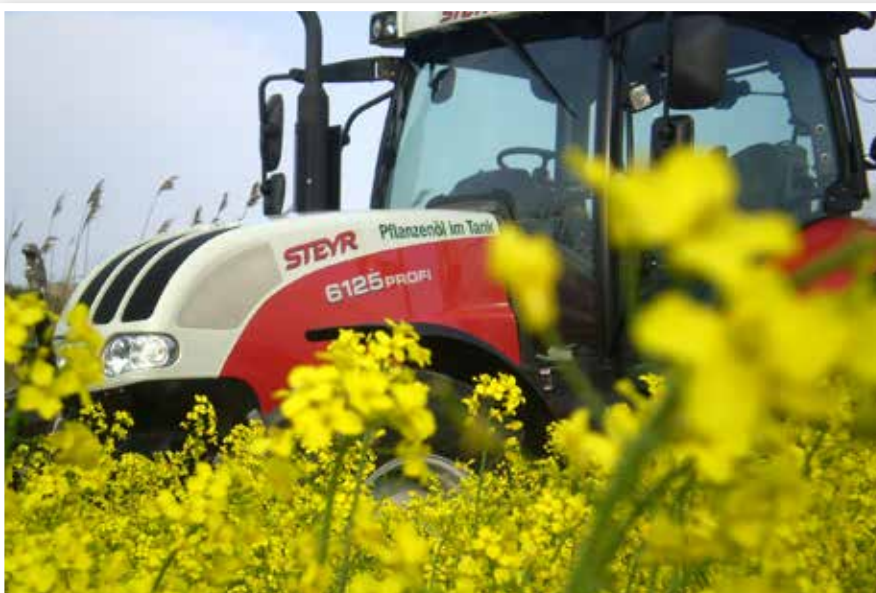
Auf Pflanzenöl umgerüsteter Traktor im Einsatz auf dem Rapsfeld
