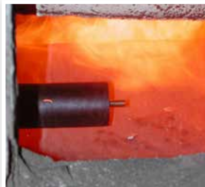
Messungen im heißen Rauchgas/Produktgas mit speziell entwickelten Absaugsonden
