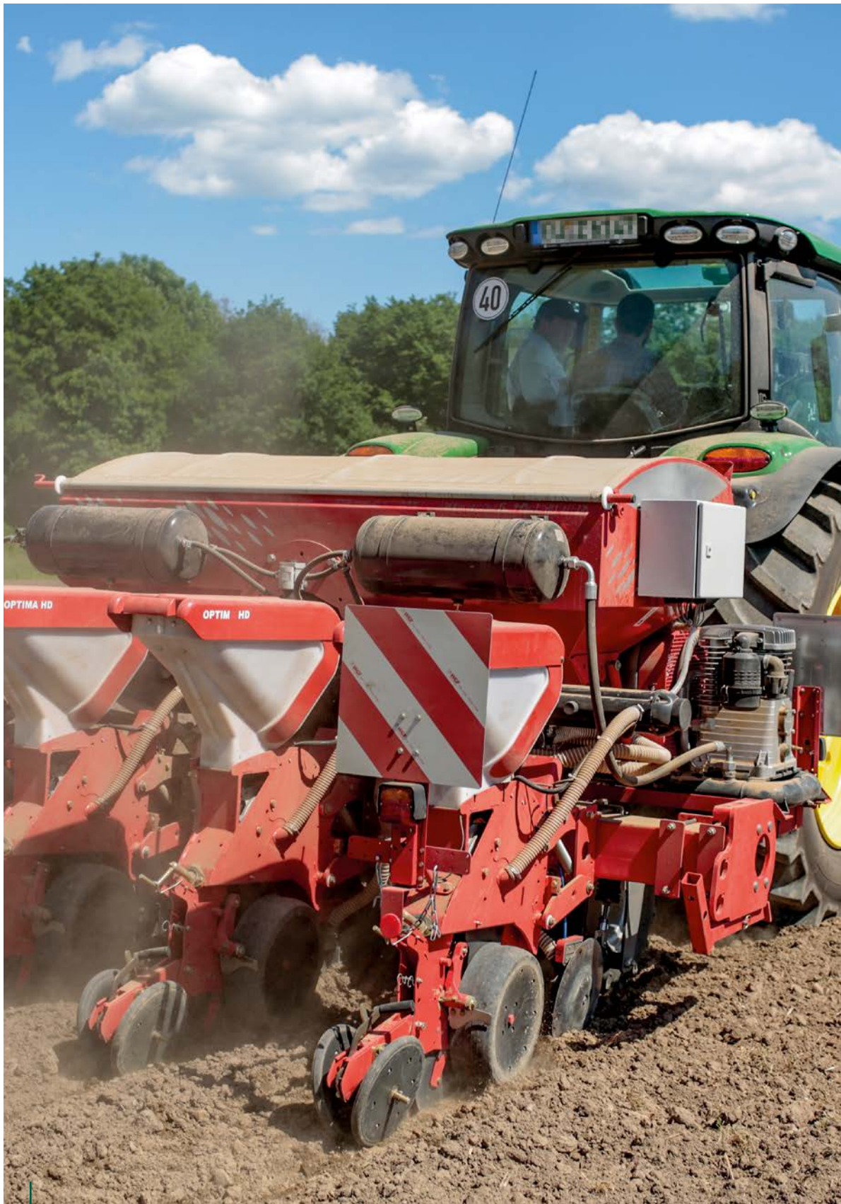
Das Team der TH Köln entwickelte eine neuartige Portioniereinheit für den Einsatz an einer herkömmlichen Einzelkornsämaschine, die für alle granulierten Düngerarten ausgelegt ist.
