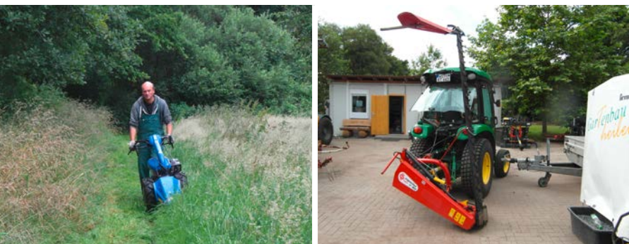
Links: Mahd mit einem handbetriebenen Balkenmäher, rechts: Mähmaschine mit Doppelmesserbalken.
