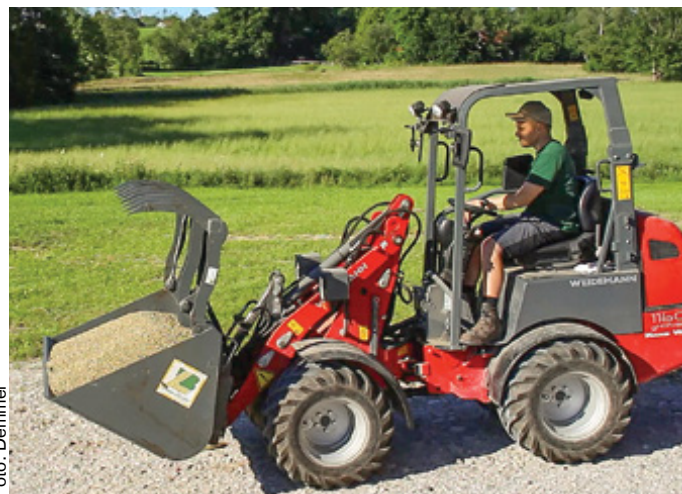
◁ Der E-Hoftrac ist eine der Maschinen auf dem Betrieb Demmel, die mit Solarstrom geladen wird.
