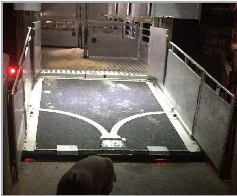
Foto 1: Geeignete seitliche Begrenzungen einer Laderampe eines Transportfahrzeuges für Schweine (Quelle: LK Heidekreis)
