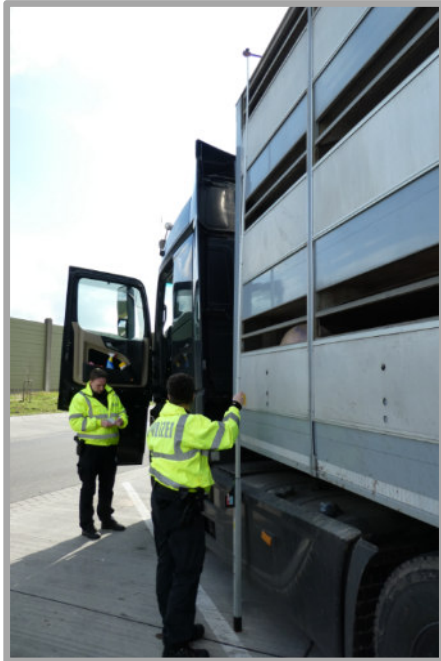
Foto 3: Ermittlung der Transporthöhe von Tiertransportfahrzeugen (Quelle: LAVES, Tier- schutzdienst)
