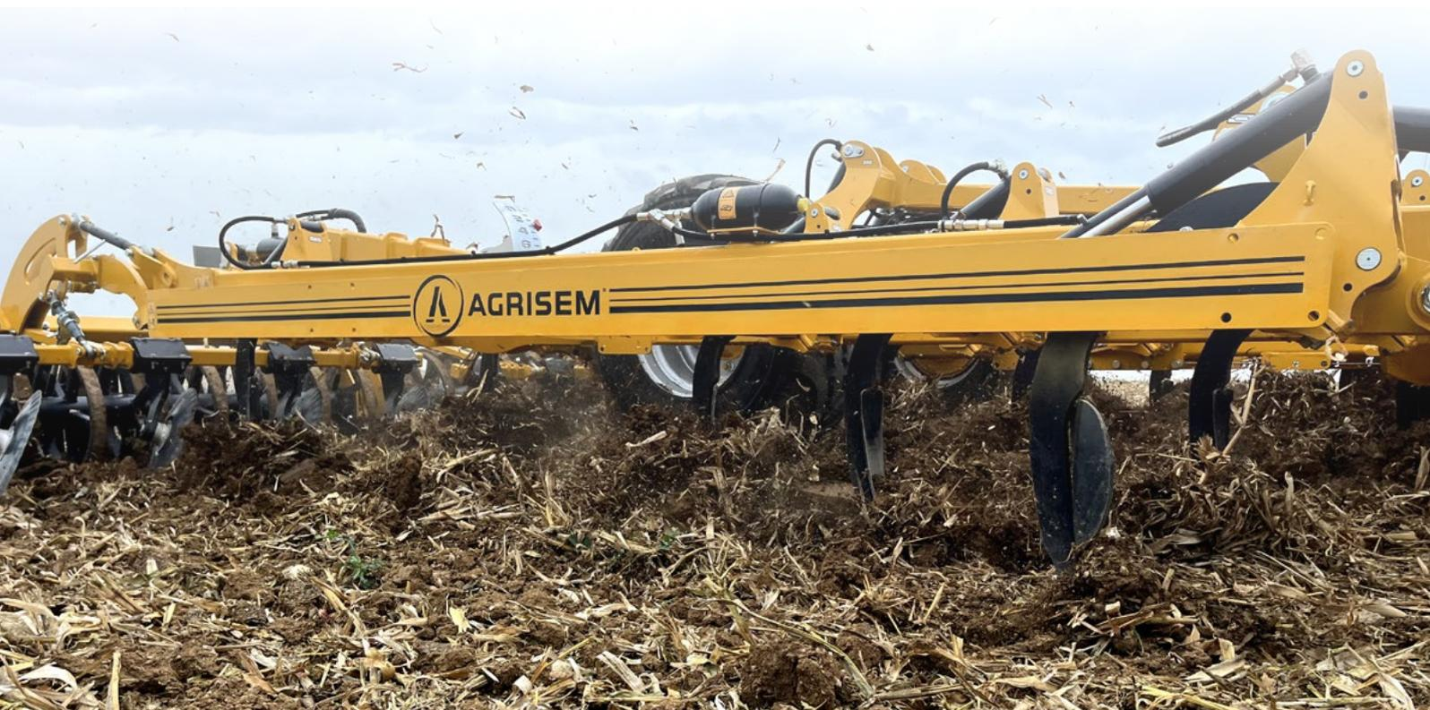
Die Tiefenverstellung erfolgt hydraulisch und kann von der Kabine aus stufenlos eingestellt werden, wobei die Synchronisation zwischen den Walzen und den vorderen Stützrädern zur Standardausstattung gehört.
