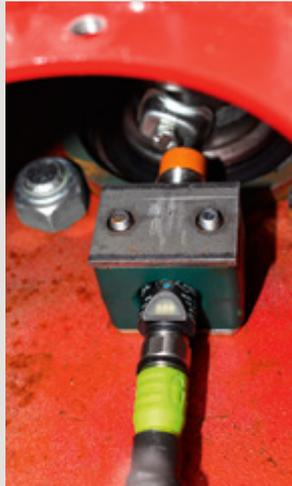
Die Drehzahlsensoren sind im Holm gut geschützt.
