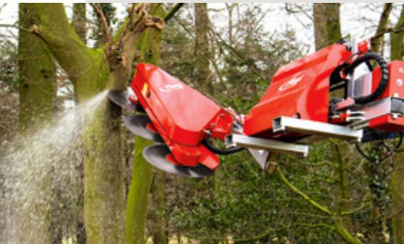
Mit der Säge lassen sich auch Starkäste in jeder Position schneiden.
