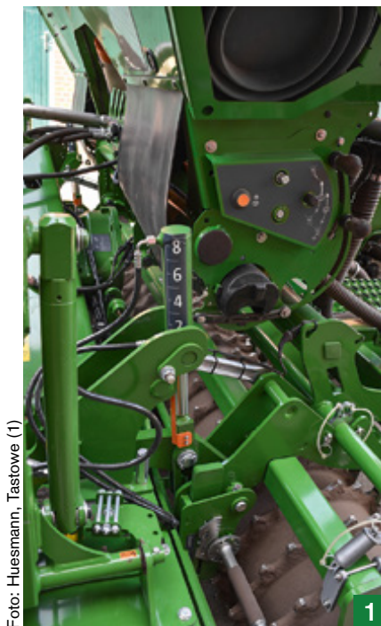
△ 1) Das Abdrehen des Düngers erledigt man an der linken Maschinenseite. 2) Die Vereinzlungsscheiben lassen sich werkzeuglos ausbauen. 3) Für den Scharddruck sorgt eine Feder.
