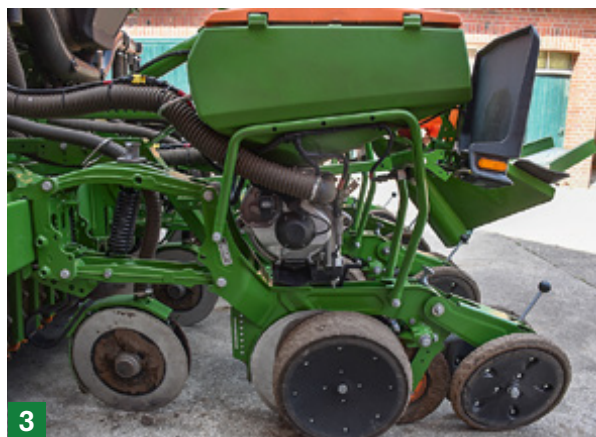
△ 1) Das Abdrehen des Düngers erledigt man an der linken Maschinenseite. 2) Die Vereinzlungsscheiben lassen sich werkzeuglos ausbauen. 3) Für den Scharddruck sorgt eine Feder.
