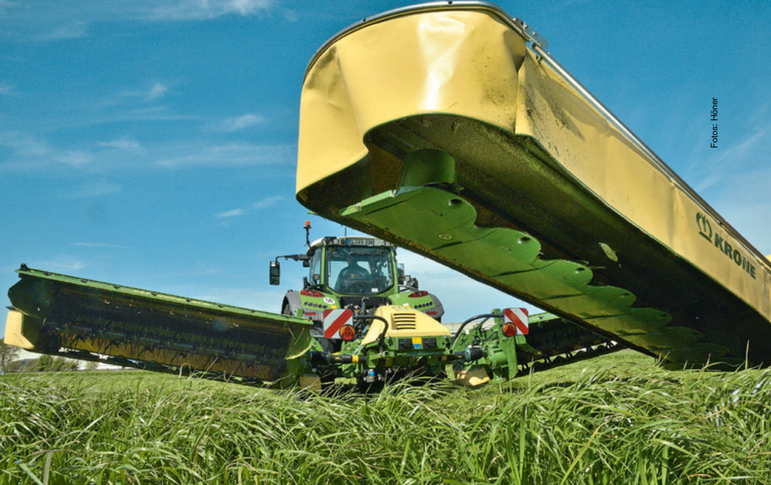
△ Gleiche Arbeitsbreite, aber schlankere Bauform: Ohne Aufbereiter bringt die Mähkombi ein deutlich geringeres Einsatzgewicht.
