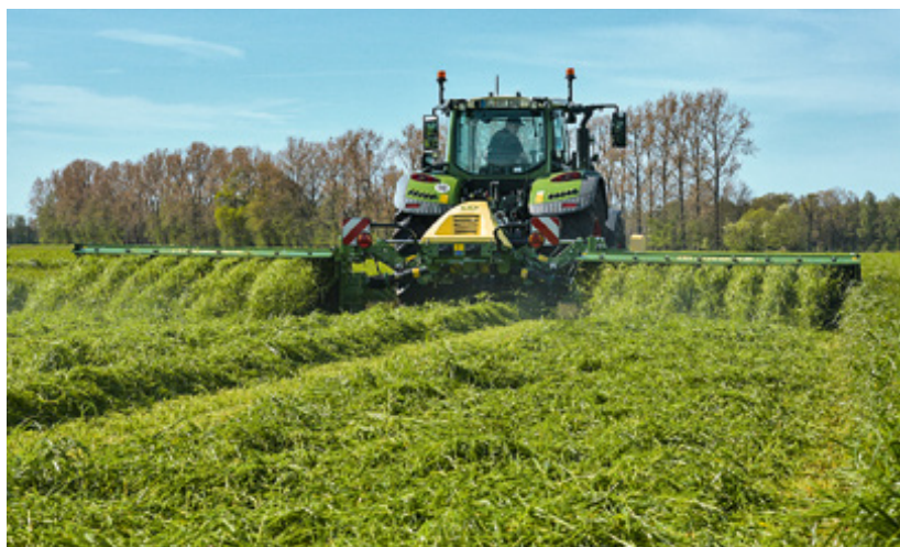
△ Den Einsatz des Aufbereiters erkennt man bereits beim Mähen mehr als deutlich. Das Futter wird intensiv geknickt (rechts) und kann so schneller abtrocknen. Ohne Aufbereiter (links) liegen die Grashalme nahezu unberührt in der Reihe.
