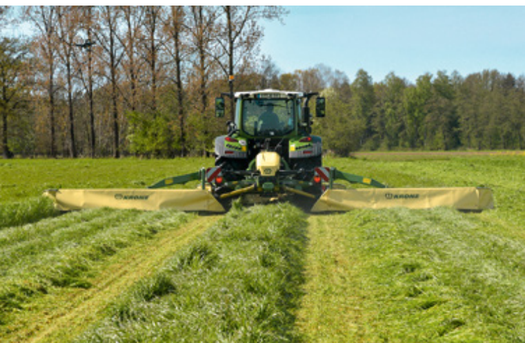
△ Den Einsatz des Aufbereiters erkennt man bereits beim Mähen mehr als deutlich. Das Futter wird intensiv geknickt (rechts) und kann so schneller abtrocknen. Ohne Aufbereiter (links) liegen die Grashalme nahezu unberührt in der Reihe.
