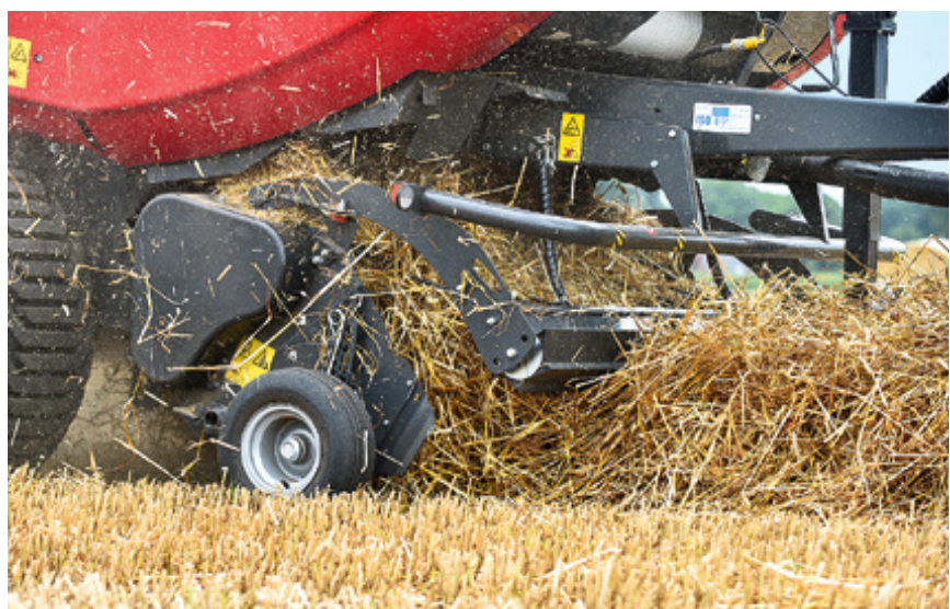
△ Die Pick-up hat das Futter immer sauber aufgenommen, auch bei höheren Fahrgeschwindigkeiten. Der Rollenniederhalter ist über Ketten in der Höhe einstellbar.
