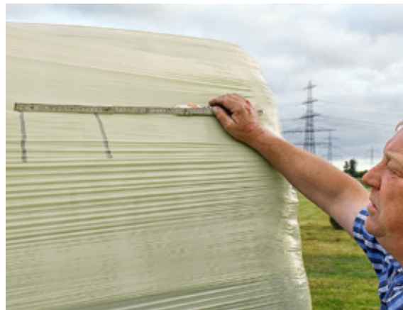
△ Beträgt der Abstand am Ballen anschließend rund 17 cm, ist die Vorstreckung passend eingestellt.
