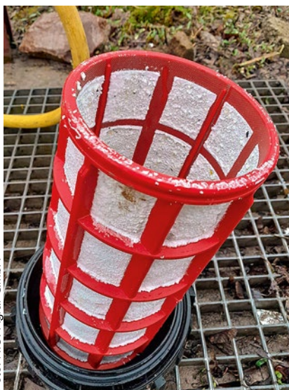
△ Bricht der Emulgator zusammen, flockt die Mischung schnell aus.
